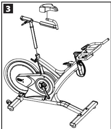
Συνδέστε τον σωλήνα στήριξης της σέλας (43) στο ποδήλατο. Βάλτε τη σέλα (1) στο σωλήνα ρύθμισης της (42) και στερεώστε την με το πόμολο. Βάλτε τον σωλήνα ρύθμισης (42) στον σωλήνα στήριξης (43) και σταθεροποιήστε τον. Με το πόμολο (6) μπορείτε να ρυθμίσετε το ύψος της σέλας.
